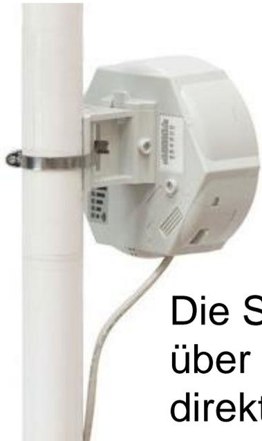
Die Stromversorgung erfolgt über das Netzkabel, direkt aus dem Router (PoE)
